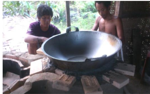
Pemanasan Ruang Bakar Utama Untuk Mengeringkan/ Memperkokoh Perekat Sambungan Yang Digunakan
