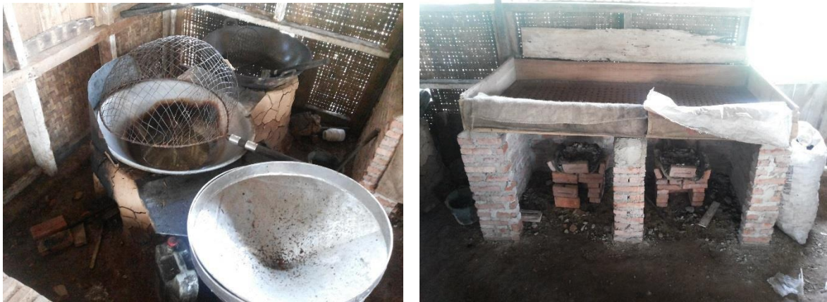
Gambar 2. Kondisi Tungku Penggoreng Kerupuk Lempit baru 2 bulan dibuat dan Sudah Retak-Retak , Dengan Tanpa Knalpot yang Layak juga (Gambar kiri). Sistem Pengering sederhana menggunakan arang pada saat panas matahari kurang atau saat musim penghujan (Gambar kanan)
