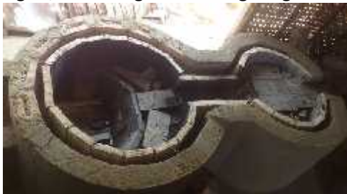
Gambar 1. Tungku Bata Api SK32 dengan isolator Heat Losses
