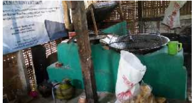
Gambar 3. Tungku Bata Api SK32 Berbahan Bakar Solar (Biru) dan Kayu Bakar (Hijau)
