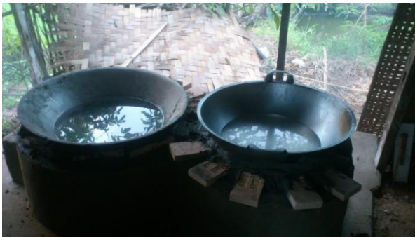
Pemanasan Ruang Bakar Utama Untuk Mengeringkan/ Memperkokoh Perekat Sambungan Yang Digunakan
