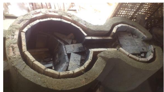
Pembuatan Ruang Bakar Kedua dan Pemasangan Batu Bata Biasa Untuk Menutupi Batu Bata Tahan Api, sebagai Isolator Panas
