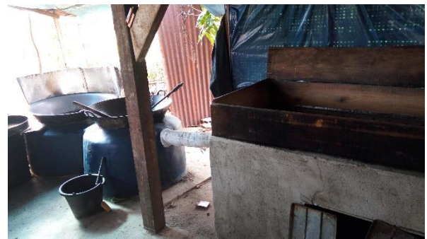
Pemanasan Ruang Bakar Utama Untuk Mengeringkan/ Memperkokoh Perekat Sambungan Yang Digunakan
