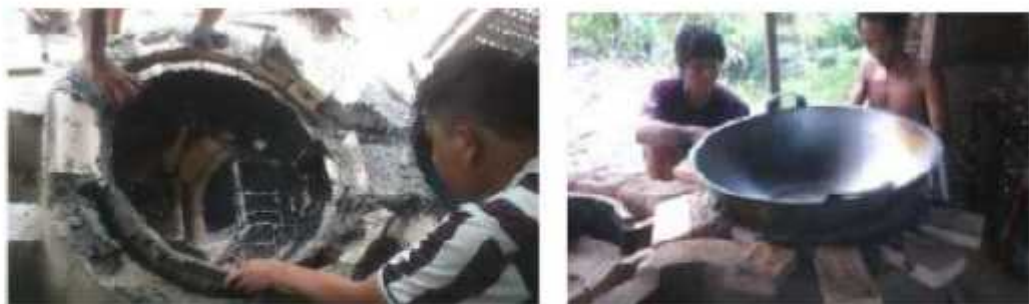
Gambar 3.4 Pemanasan Ruang Bakar Utama Untuk Mengeringkan/ Memperkokoh Perakat Sambungan Yang Digunakan, dan Pembuatan Dudukan Wajan Penggorengan
