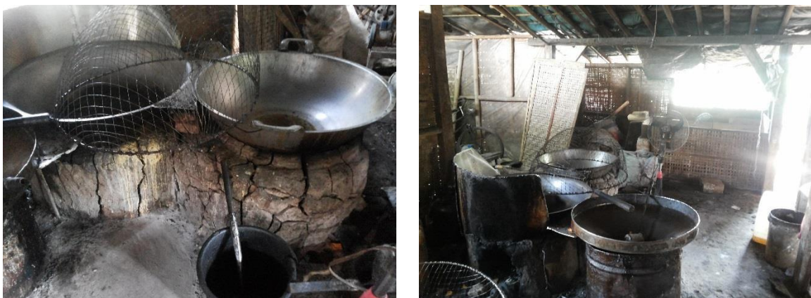
Gambar 1. Kondisi Tungku Penggoreng Kerupuk Lempit Masyarakat Yang Sangat Memprihatinkan, dan Sudah Retak-Retak , Dengan Tanpa Knalpot yang Layak (gambar kiri), dan kondisi lingkungan Kerja Yang Tidak Nyaman dan Tidak Sehat (Gambar kanan)
