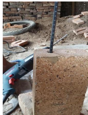
Gambar A4. Pengeboran bata api (kiri), mengukur kedalaman (kanan)
