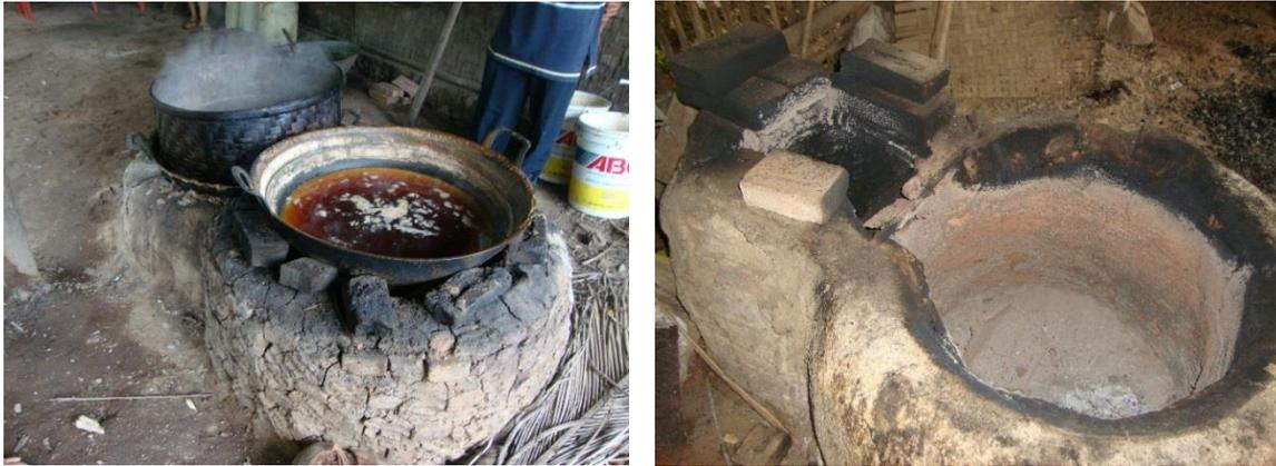
Gambar 2. Kondisi Tungku Masak Gula Merah Masyarakat Yang Sangat Memperhatikan, dan **Sudah Retak-Retak**, Dengan **Tanpa Knalpot** yang Layak. Survey Di Dua Lokasi.
