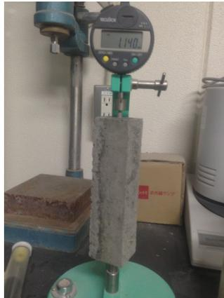
Gambar 1c. Pengujian ekspansi untuk mortar.
