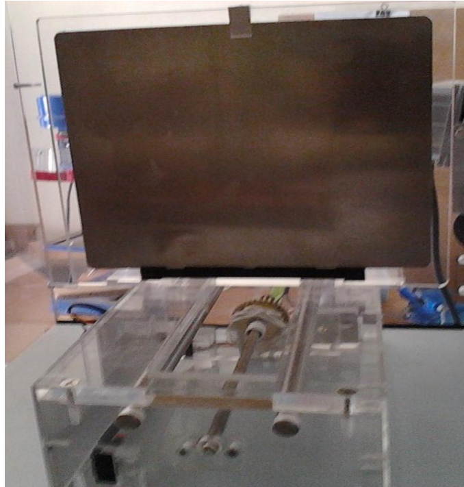
Gambar 12. Sistem plat kolektor tempat pembentukan sampel nanofiber
