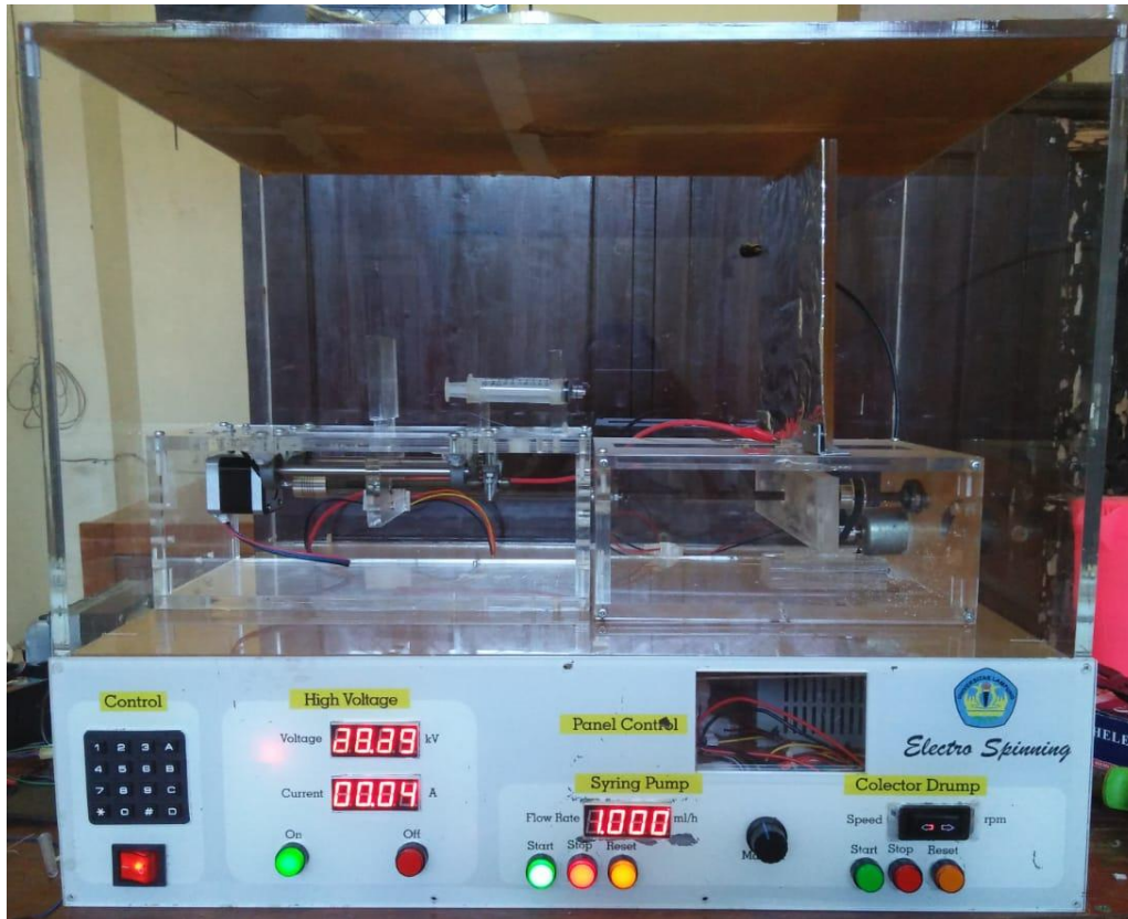
Gambar 13. Alat pemintal serat nano (electrospinner) berbasis arduino nano
