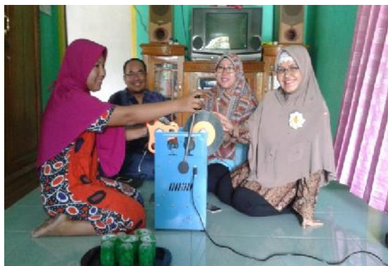
Gambar 2. Proses penutupan kemasan menggunakan cup sealer
