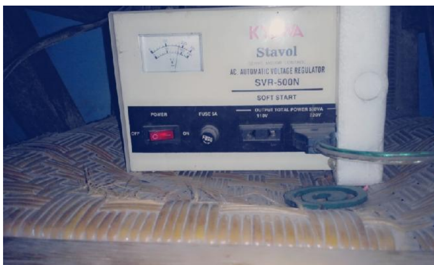
Gambar 5. Tegangan listrik terukur sebesar 200 Volt
