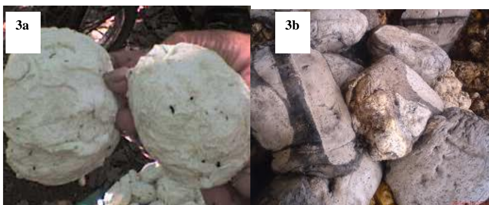
Gambar 3. Karet hasil pembekuan: (a) dengan asam zat pembeku yang dibuat; (b) dengan asam sulfat atau tawas
