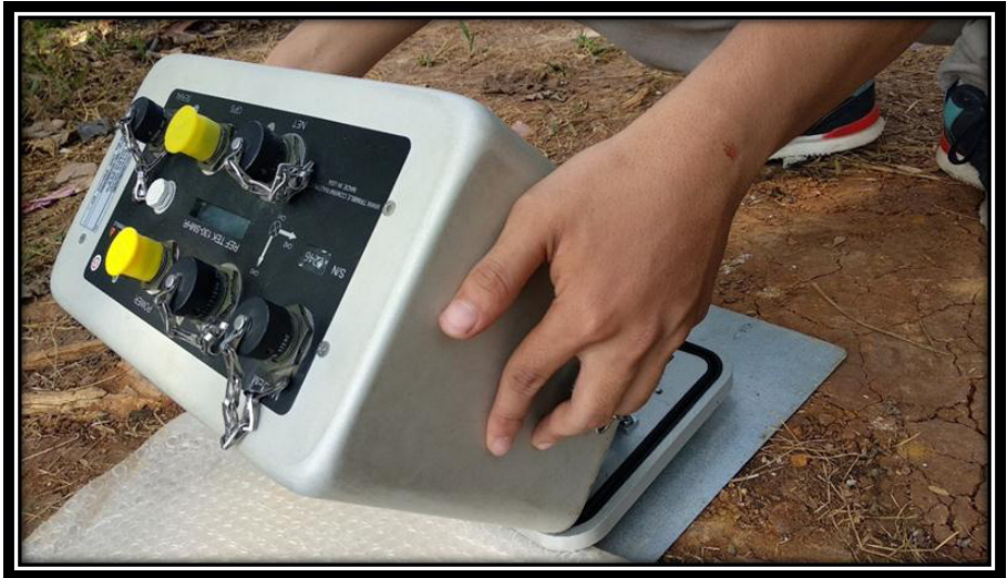
Gambar 6.2. Membuka alat mikrotremor.
