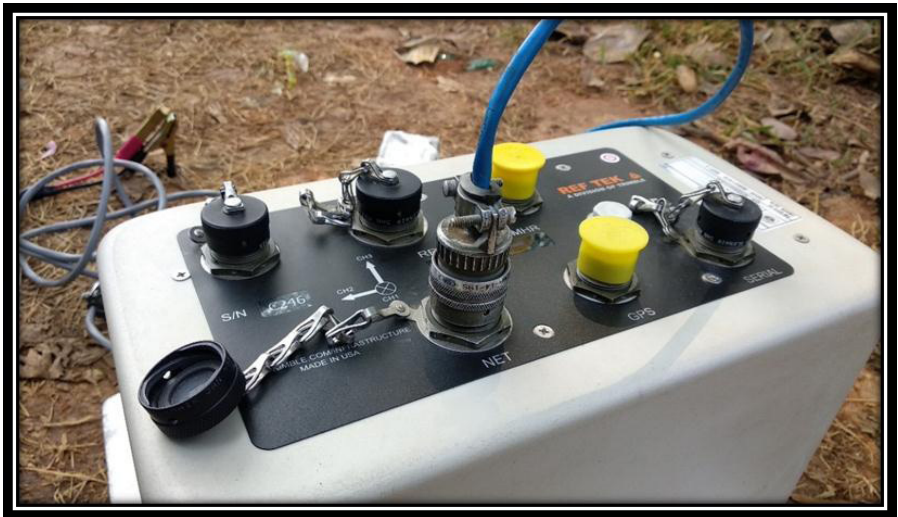
Gambar 6.4. Kabel LAN terhubung pada alat.
