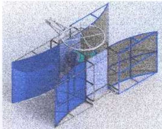
Gambar 3. Skema sistem PLTMH menggunakan turbin helik yang akan digunakan pada saluran irigasi Way Tebu.
