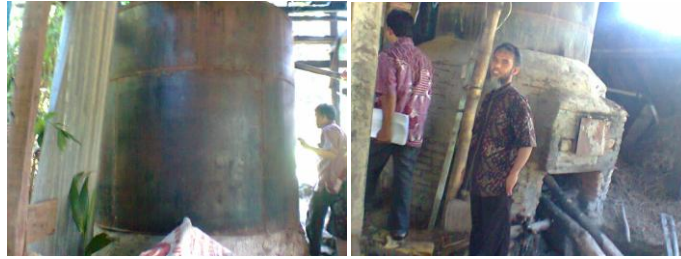
Gambar 3. Ketel penyulingan di Lasusua yang terbuat dari plat besi
