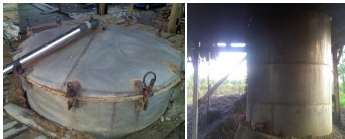
Gambar 4. Ketel penyulingan dari bahan stainless steel
