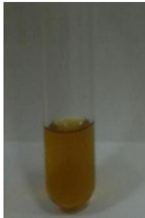
Gambar 5. Minyak nilam dari Lasusua yang dihasilkan dari alat penyulingan menggunakan bahan besi plat
