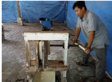
Gambar 8. Proses pengepresan ampas ubikayu
