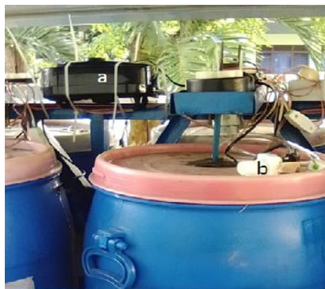
Gambar 5. Aktuator Pompa Udara (a) dan Aktuator Keran Udara (b)
