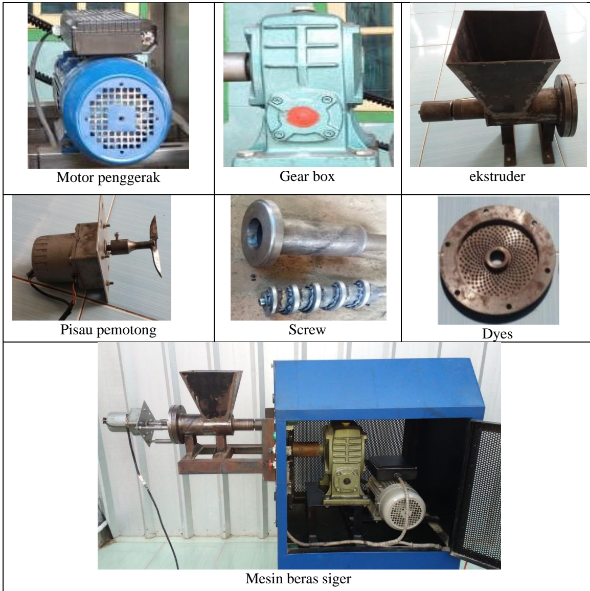
Gambar 6. Komponen mesin beras siger
