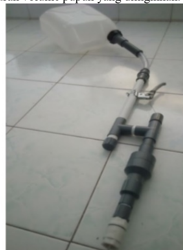
Gambar 4.1 Aplikator Pupuk Cair Setelah Dilakukan Modifikasi
