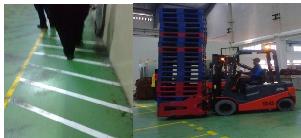
Gambar 5. Safety line atau akses jalan antara forklif dan pejalan kaki dibedakan
