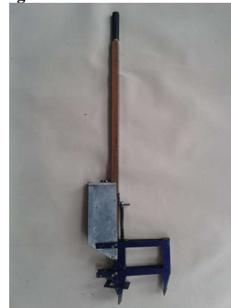
Gambar 2 Tugal Benih Kedelai Hasil Perancangan (Skala 1:15)
