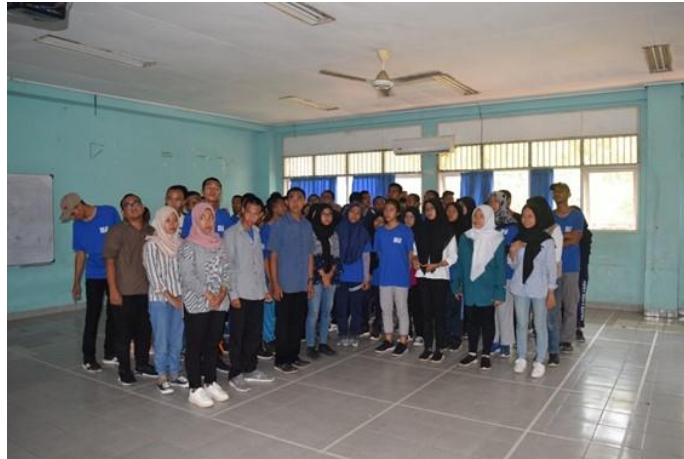
Gambar 11. Setting pemebanan untuk 80 orang ditempatkan diatas balok anak menyilang diantara tengah pelat
