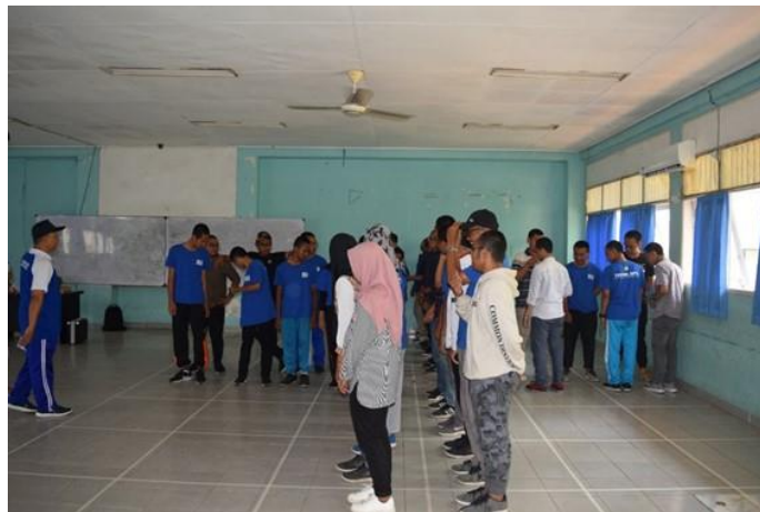
Gambar 9. Setting pembebanan untuk 40 orang pada pelat difokuskan diatas balok anak menyilang dibawah pelat.
