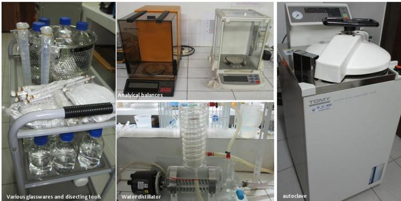
Gambar 3.2. Beberapa peralatan yang dibutuhkan di ruang persiapan media: kereta dengan akuades steril, alat-alat gelas dan alat-alat diseksi, timbangan, distilator air, dan autoklaf.
