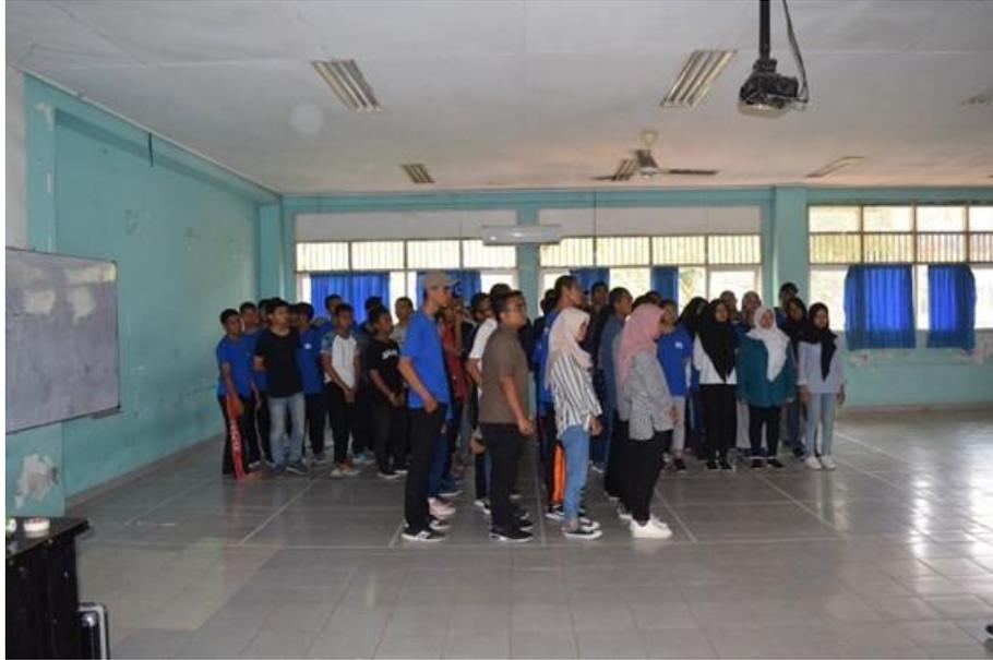
Gambar 4.18 Setting pembebanan untuk 80 orang ditempatkan diatas balok anak menyilang diantara tengah pelat (tampak samping)
