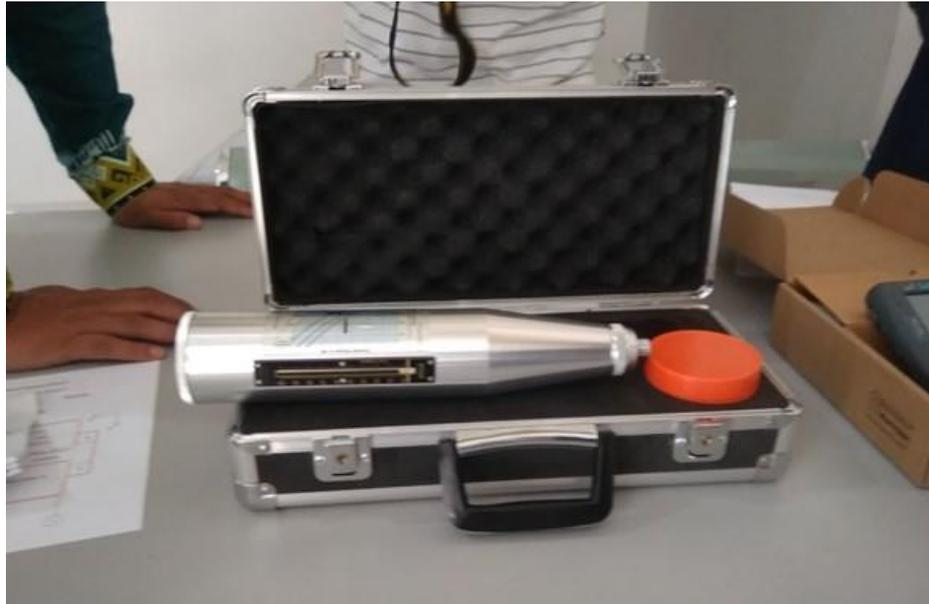
Gambar 3.2 Uji Non-destructive dengan Hammer Test.
