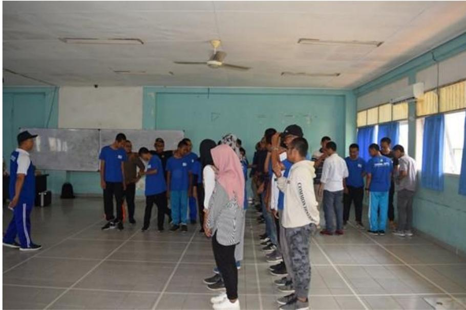
Gambar 4.16 Setting pemebanan untuk 40 orang pada pelat difokuskan diatas balok anak menyilang dibawah pelat.
