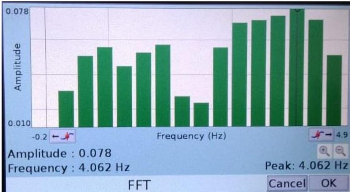
Gambar 4.16 Analisis FFT untuk pelat yang dibebani oleh 20 orang yang difokuskan pada daerah sekitar diatas balok anak menyilang pada pelat.
