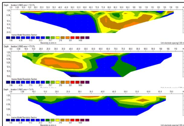
**Gambar 4.** Penampang 2D hasil pengukuran geolistrik di lingkungan yayasan Nurul Huda dengan konfigurasi Wenner-Schlumberger.
