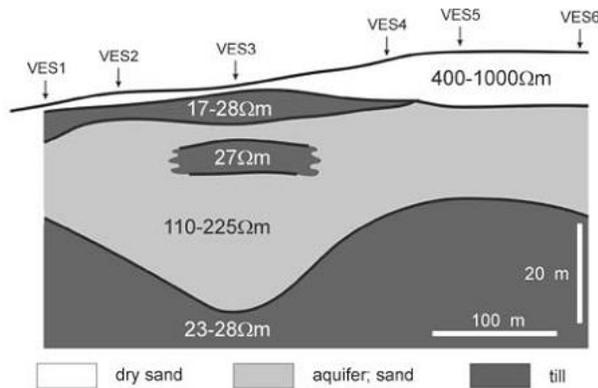
**Gambar 2.** Profil kedalaman resistivitas hasil pemodelan data geolistrik (Kirsch, 2006).
