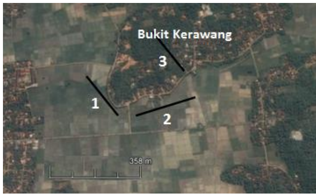
Gambar 3. Posisi 3 lintasan ukur geolistrik 2D
