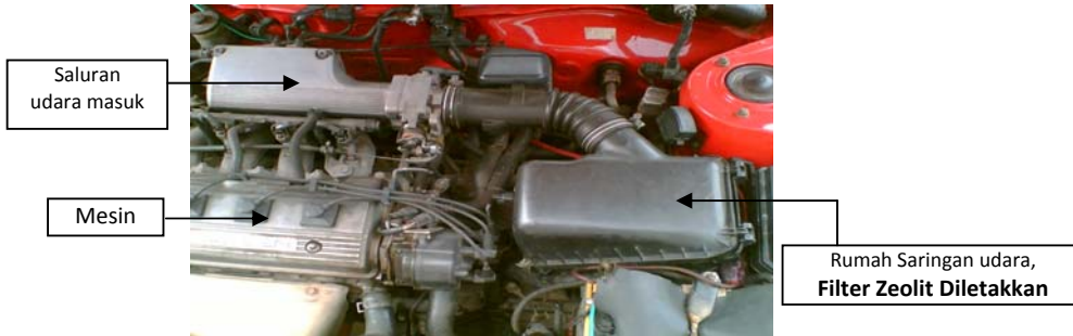
Gambar 2. Letak Filter Zeolit Pada Rumah Saringan Udara Mobil EFI
