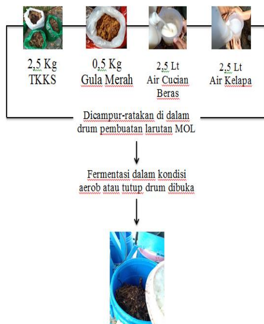
Gambar 1. Proses pembuatan Larutan MOL TKKS secara aerob
