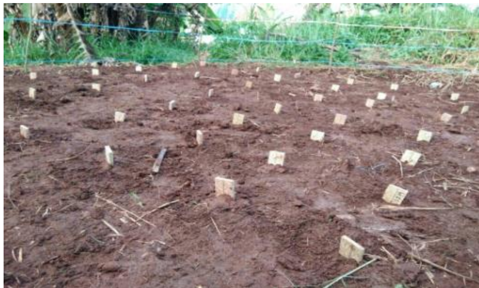
Gambar 1 Uji kubur papan partikel.
