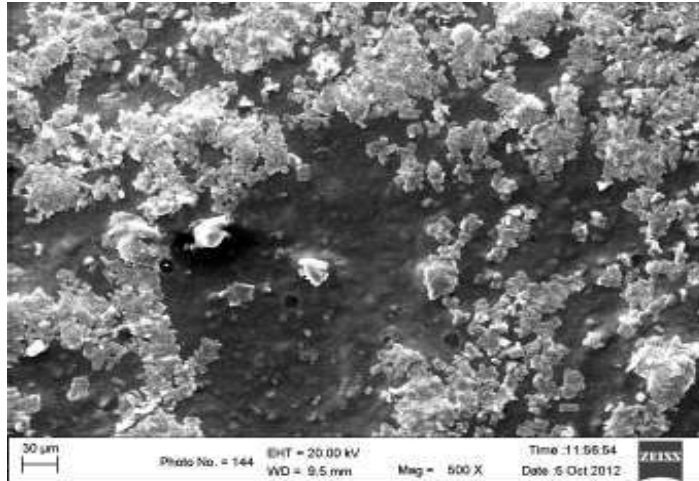
Gambar 1. Hasil analisa SEM sampel bioplastik dengan perbesaran 500x
