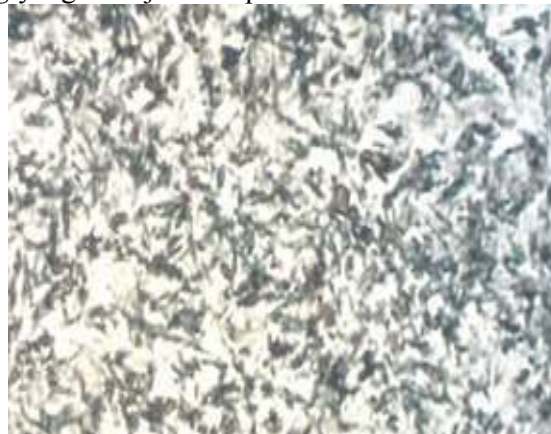
Gambar 2. Struktur mikro quenching oli.
