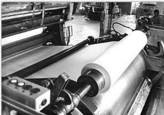
Ukuran meningkatkan itu kertas tahan air, menurunkan kemampuan untuk bulu, mengurangi kasar, dan meningkatkan pencetakan sifat dan kekuatan ikatan permukaan. Beberapa mesin kertas juga menggunakan sebuah 'pelapis tipe' untuk menerapkan lapisan dari pengisi seperti kalsium karbonat atau lempung cina. Kertas meninggalkan mesin yang terguling untuk diproses lebih lanjut.
