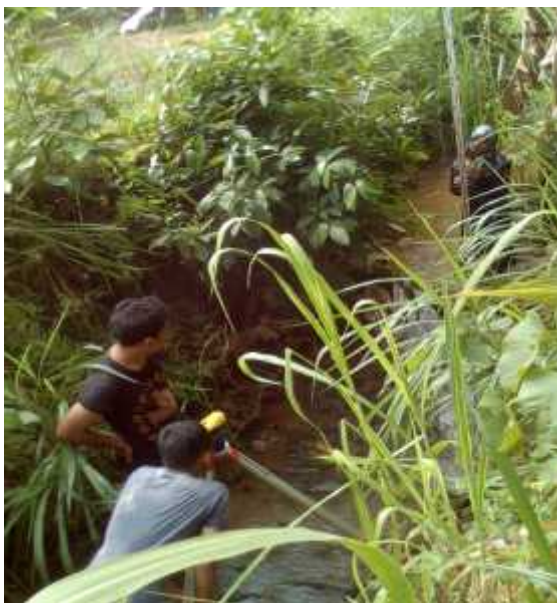
Gambar 5. Tim pelaksana melakukan pengukuran untuk mengetahui potensi tinggi jatuh aliran dan tinggi pemompaan.
