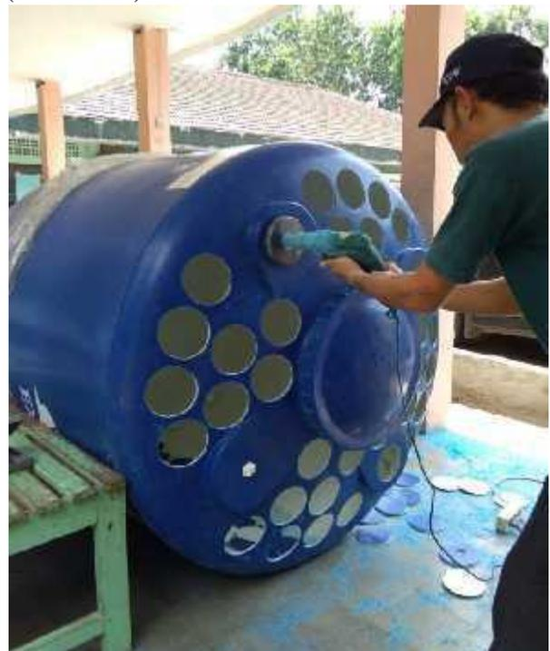
Gambar 8. Pembuatan lubang tambahan pada tanki
