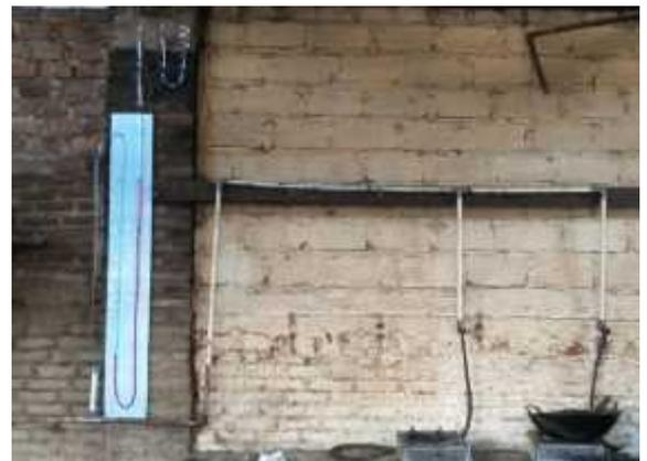
Gambar 6 Pemasangan manometer U
