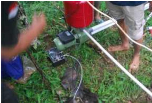
Gambar 13. Pompa air berbasis mikrokontroler terpasang
