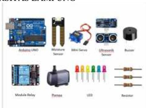
Gambar 1. Alat dan Bahan Pengairan Otomatis
