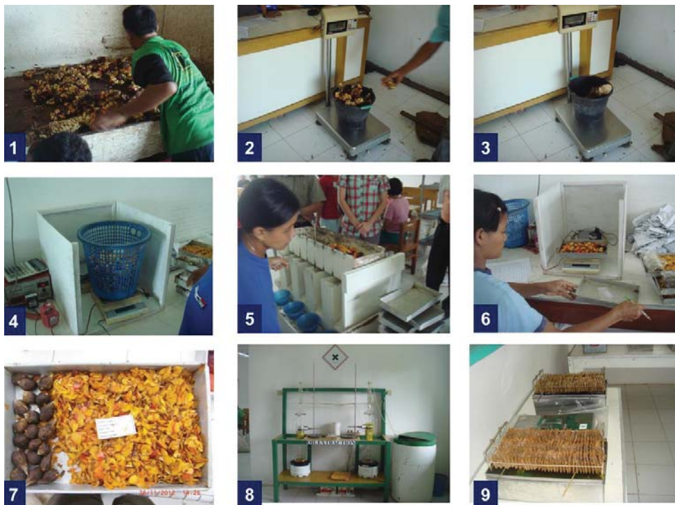
Gambar 3.10. Skema proses analisis tandan : 1) pengacakan sampel, 2) penimbangan sampel \pm 5 kg, 3) penimbangan tangkai tandan (stalk), 4) penimbangan buah, 5) pengacakan buah di bok sampel, 6) pemisahan dan penimbangan buah fertil dan partenokarpi, 7) pengirisan dan penimbangan mesokarp serta biji (inti dan kernel), 8) ekstraksi minyak dari gilingan mesokarp kering dengan soxhlet, 9) penimbangan mesokarp dalam kantong ( \pm 5 g) setelah ditiriskan dan dikeringkan dari hexane
