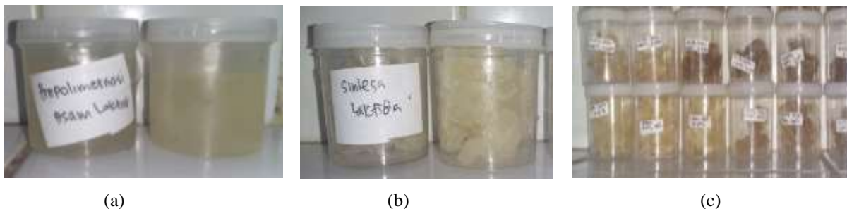
Gambar 1. Produk yang diperoleh dari tahap-tahap sintesis PLA, yaitu prepolimerisasi (a), sintesis laktida (b), dan polimerisasi (c).
