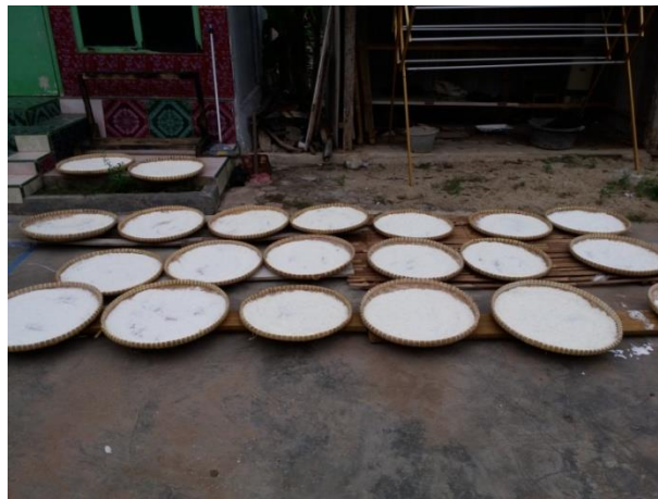
Gambar 9. Pengeringan ampas cassava dan tapioka dengan sinar matahari
