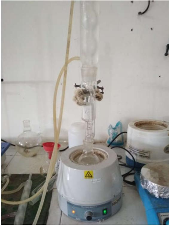
Gambar 1. Peralatan ekstraksi Soxhlet
