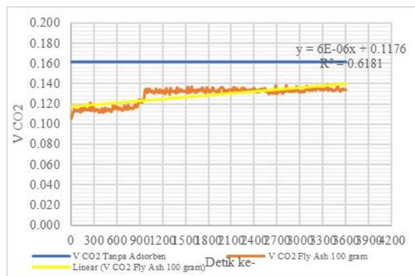
Gambar 4. Hubungan Waktu Kontak 100 gram *Fly Ash* dengan Volume Emisi CO<sub>2</sub>.
