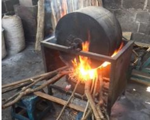
Gambar 4. Pengering drum berputar menggunakan bahan bakar kayu
