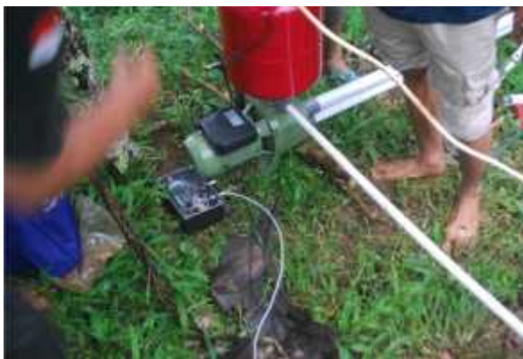
Gambar 13. Pompa air berbasis mikrokontroler terpasang
