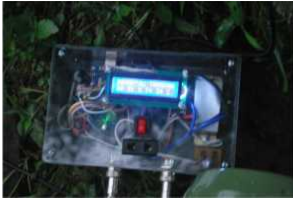
Gambar 6 Pengendali suhu dan kelembaban tanah berbasis mikrokontroler
