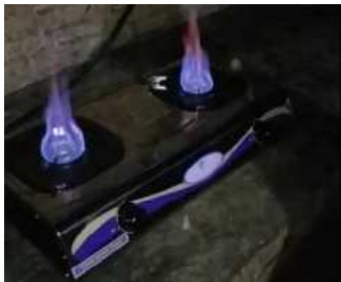
Gambar 8. Nyala api kompor setelah dipasang filter pada saluran biogas
