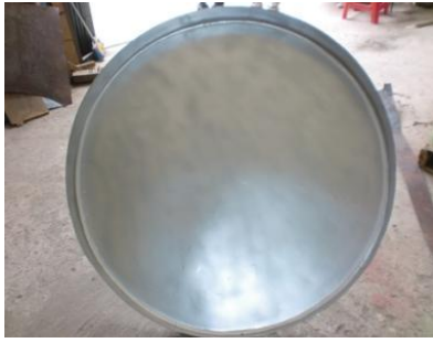
(d) bidang granulator setelah dicat Gambar 3. Proses manufaktur mesin
