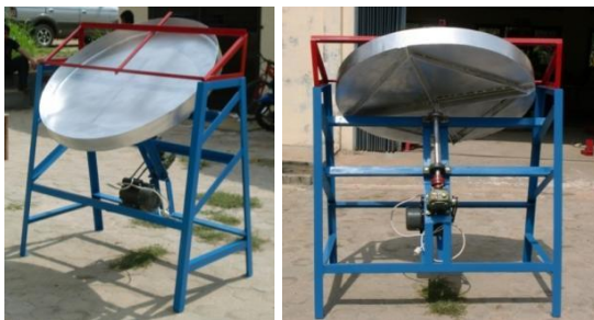
Gambar 2. Mesin pembuat butiran tiwul (beras analog) sebelum perbaikan
