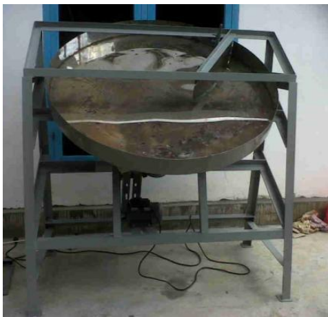
Gambar 5. Mesin pembuat butiran beras imitasi setelah perbaikan rancangan
