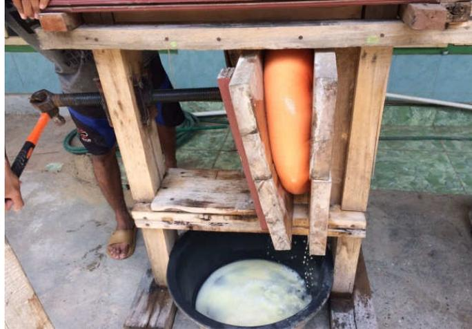
Gambar 8. Proses pengepresan ampas ubikayu
