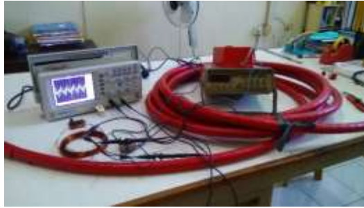
Gambar 3. Pengujian Rogowksi coil dengan input dari Function Generator
